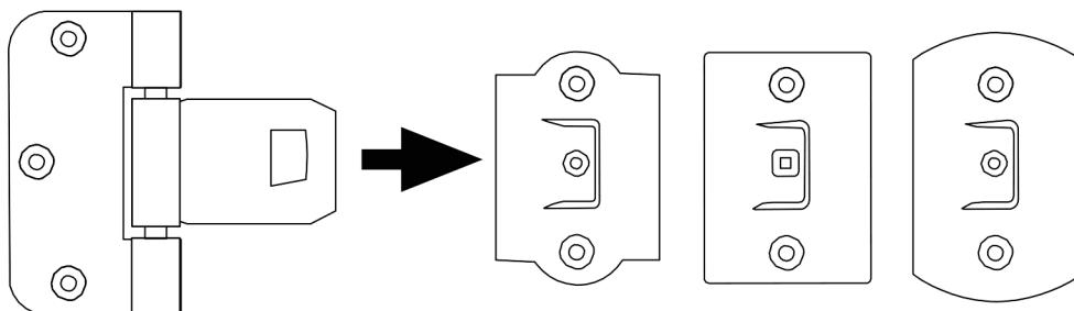
Lätsa på skruvorna till snap-in gångjärnet i dörrbladet och skjut in karmgångjärnsdelen i dörrbladet. Skruva i en skruv i mitten för extra stabilitet.
